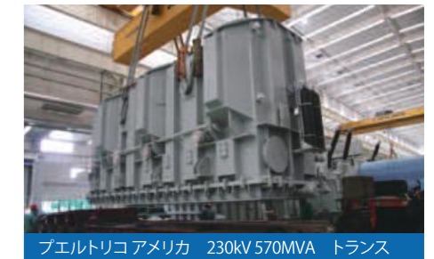
プエルトリコアメリカ 230kV 570MVA トランス
